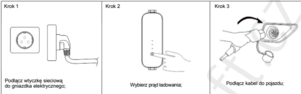
\* Przed podłączeniem kabla do pojazdu wybierz prąd ładowania, aby rozpoczęć ładowanie!
