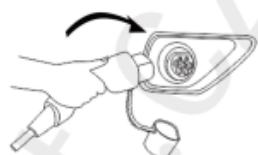
Schließen Sie das Ladekabel an das Fahrzeug an
