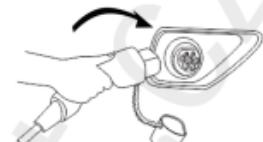
Conecte el cable de carga al vehículo;
