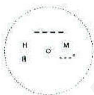
Režim měření H Měří vodorovnou vzdálenost
